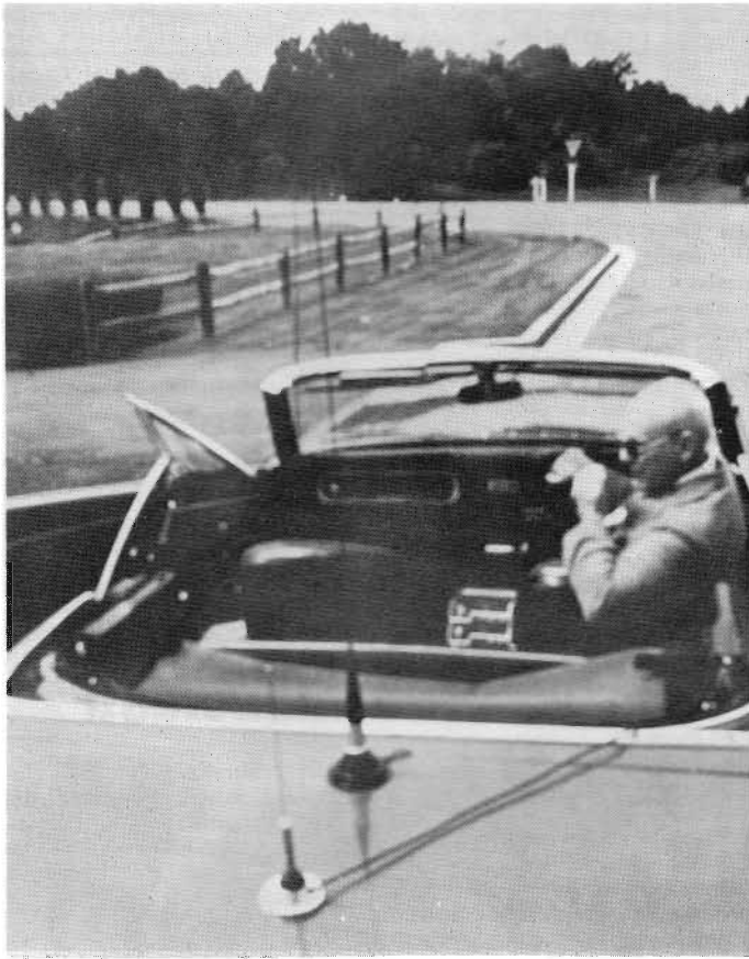
Antenna multipla da 900 MHz con 6 dB di guadagno, montata su barra mobile dietro una normale frusta nera sulla 27 MHz (chi la sperimenta è un attuale membro della FCC).
